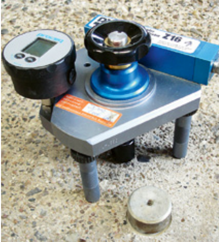
Vor der Sanierung sollte die Haftfestigkeit des Bodens mit diesem Messgerät geprüft werden.
